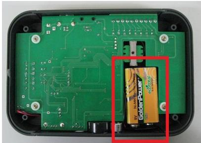
3. 電池スナップを電池から外し、新しい電池に接続します。
