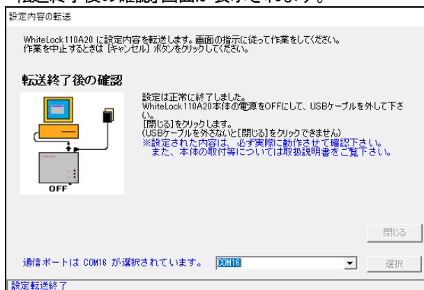
WL110A20の電源スイッチをOFFにし、USBケーブルを外して「閉じる」をクリックします。
