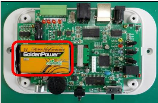
3. 電池スナップを電池から外し、新しい電池に接続します。
